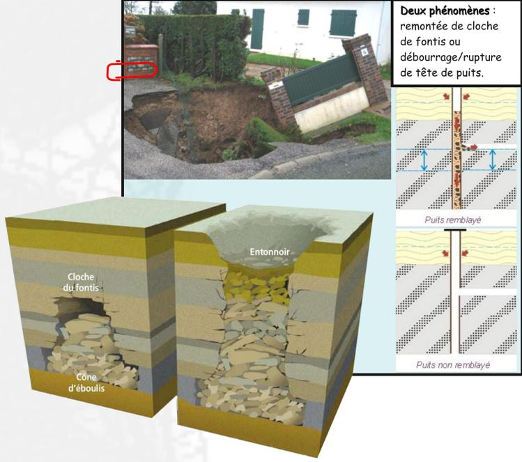
**Deux phénomènes :** remontée de cloche de fontis ou débouillage/rupture de tête de puits.
