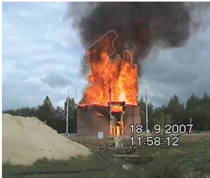
Figure 37 : Formes et surfaces des flammes lors de l'essai 2 à moyenne échelle.
